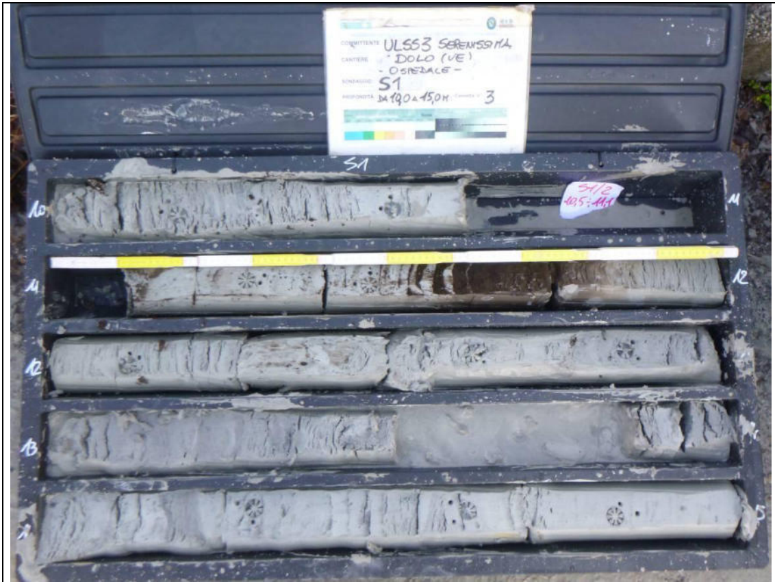
Sondaggio Geognostico S1 - Contenuto cassetta catalogatrice (10,00 – 15,00 m)
