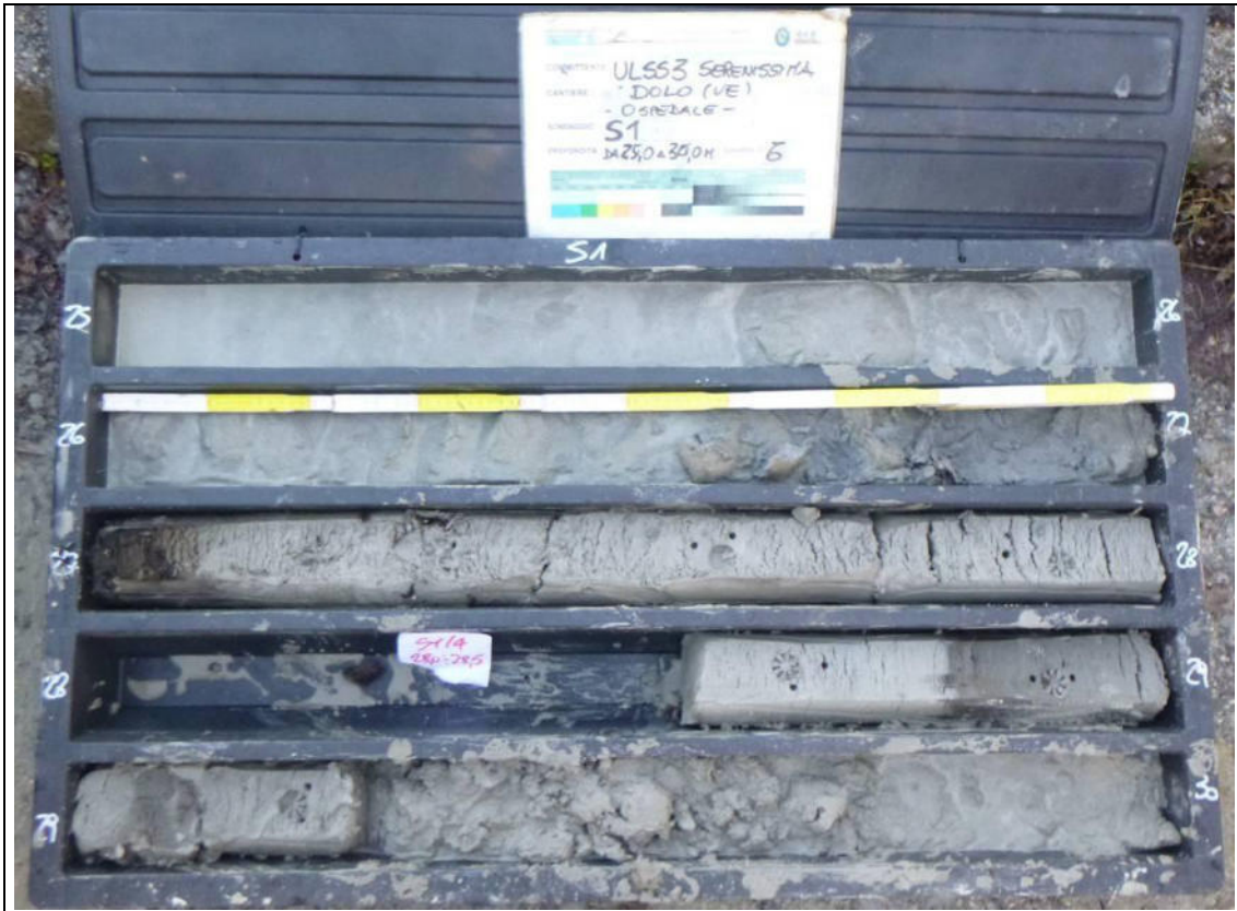
Sondaggio Geognostico S1 - Contenuto cassetta catalogatrice (25,00 – 30,00 m)
