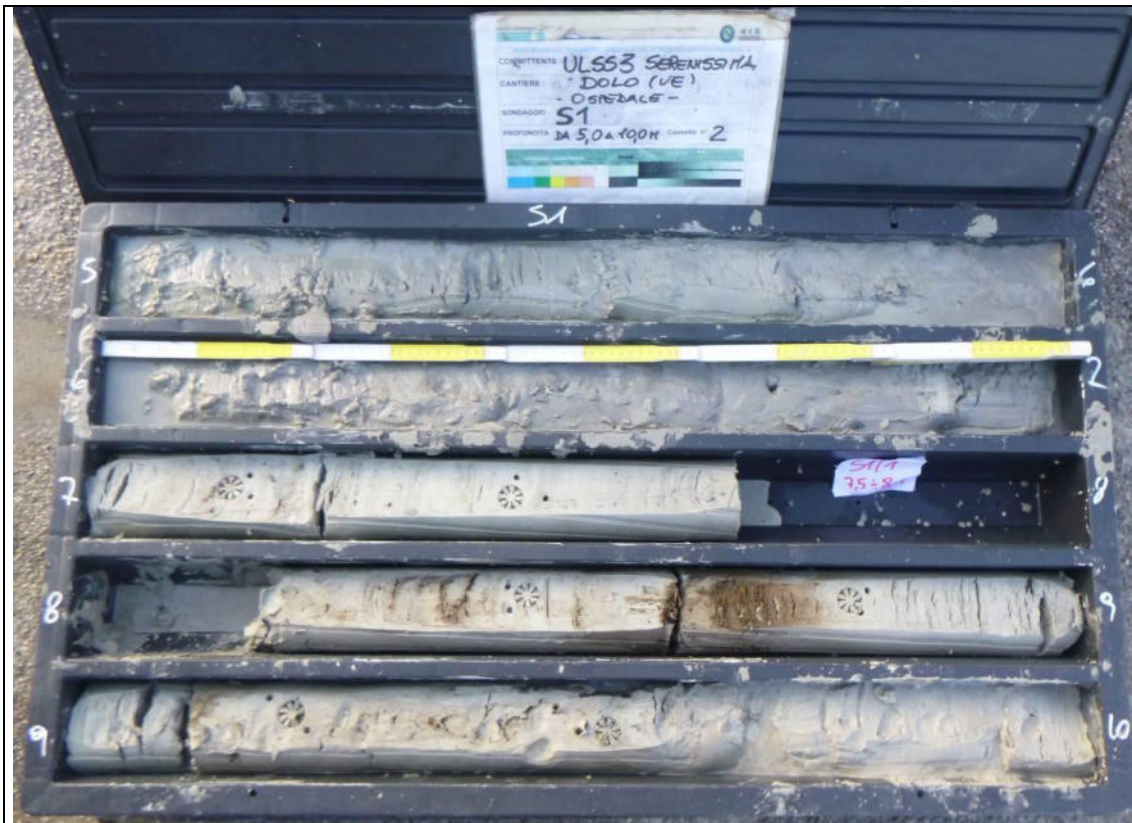
Sondaggio Geognostico S1 - Contenuto cassetta catalogatrice (5,00 – 10,00 m)
