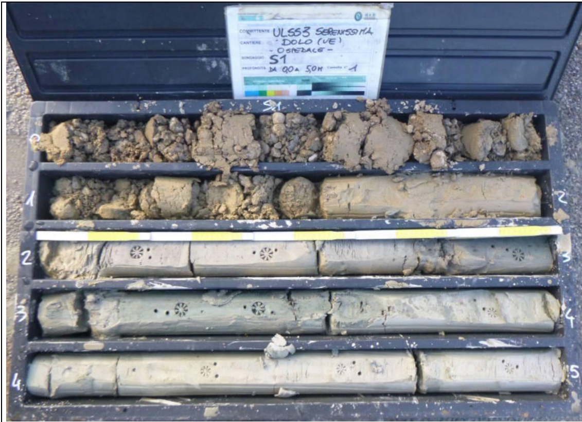
Sondaggio Geognostico S1 - Contenuto cassetta catalogatrice (0,00 – 5,00 m)
