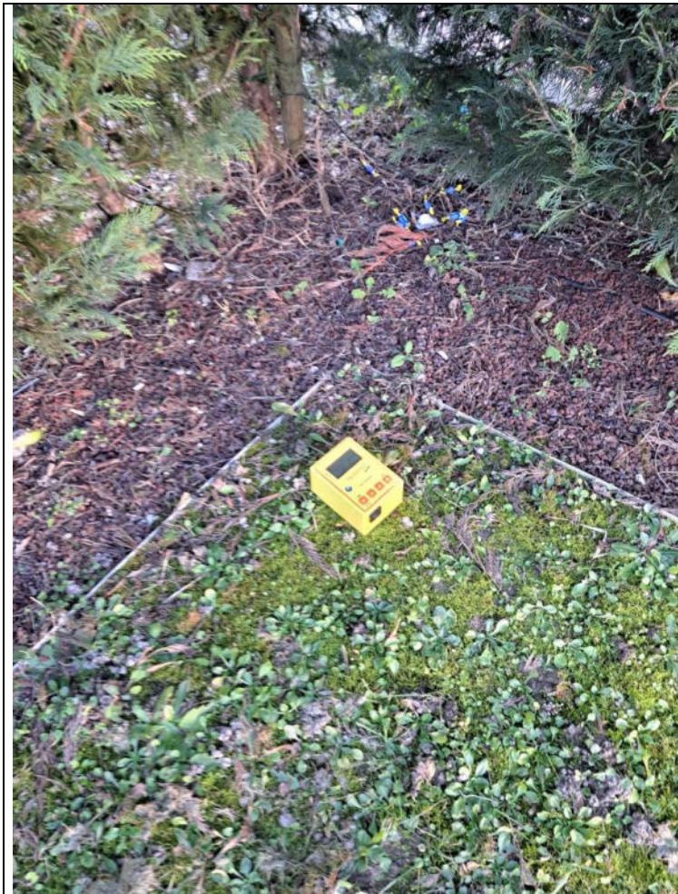
Esecuzione indagine sismica HVSR
