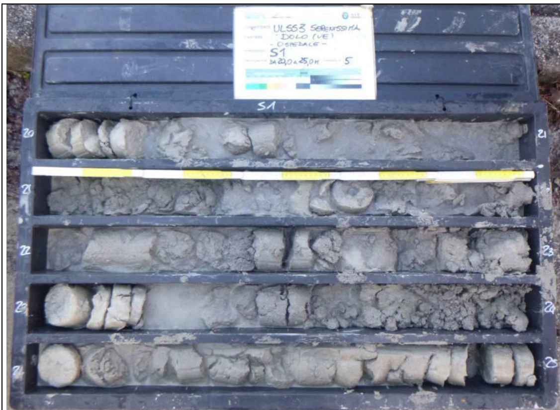
Sondaggio Geognostico S1 - Contenuto cassetta catalogatrice (20,00 – 25,00 m)
