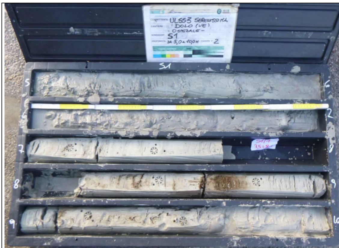
Sondaggio Geognostico S1 - Contenuto cassetta catalogatrice (5,00 – 10,00 m)
