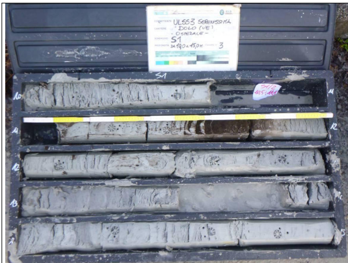
Sondaggio Geognostico S1 - Contenuto cassetta catalogatrice (10,00 – 15,00 m)
