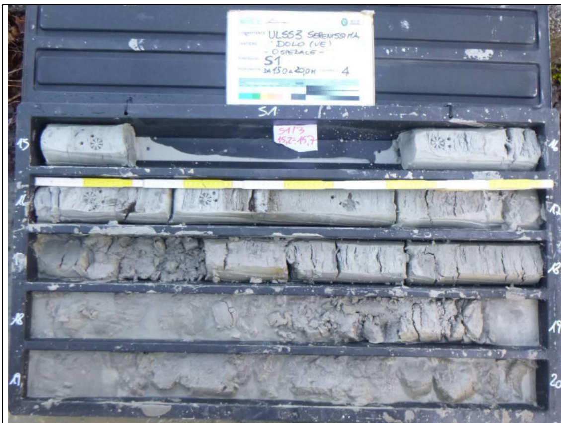
Sondaggio Geognostico S1 - Contenuto cassetta catalogatrice (15,00 – 20,00 m)
